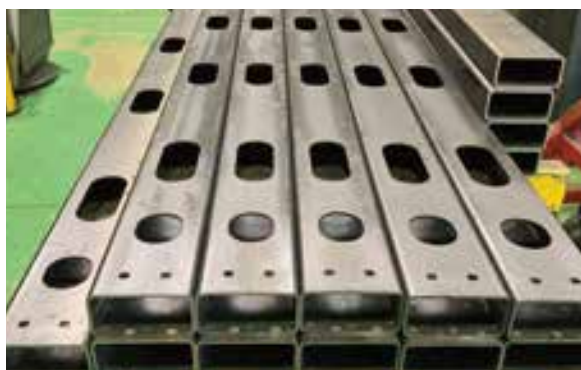
角パイプへの抜き穴対応
